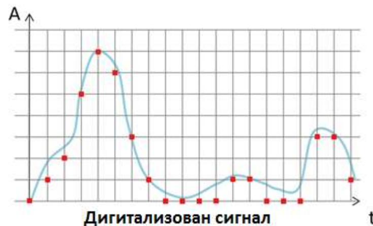
Етапе дискретизације (црвено) неког аналогног сигнала (плаво).
