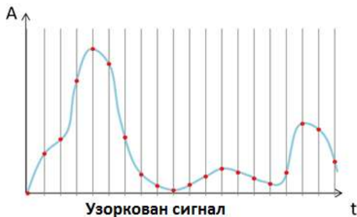
Етапе дискретизације (црвено) неког аналогног сигнала (плаво).
