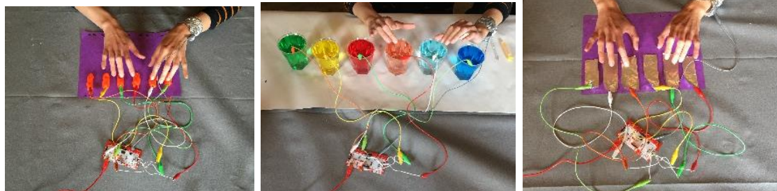
Три примера клавијатуре: дирке од пластелина (лево), стаклене чаше с водом (центар), листићи алуминијумске фолије (десно). Напомена: коло је затворено преко алуминијумског прстена повезаног са земљом ( borne « Earth » ).
