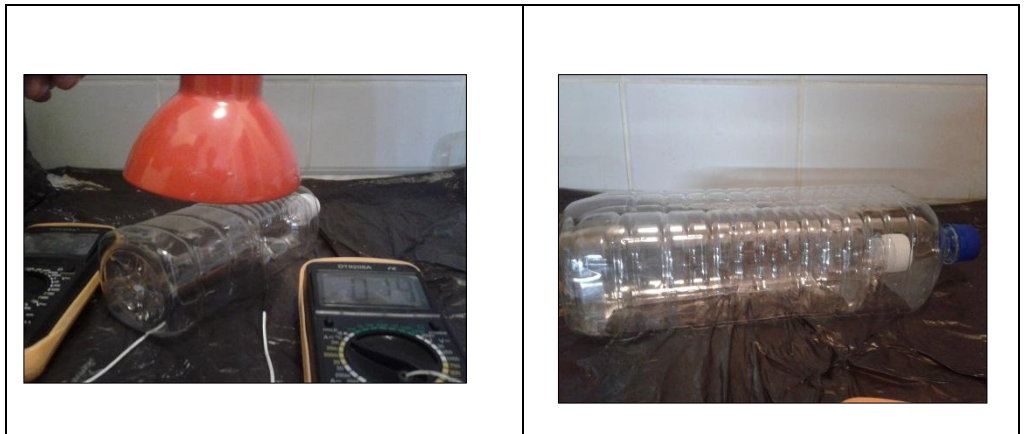
Сл.4а) Модела стаклене баште: црна фолија, два мултиметра, сијалица, део боце покрива леву сонду мултиметра, десна сонда је стављена на фолију паралелно првој сонди, б) иста поставка али са мањом у већој боци.
