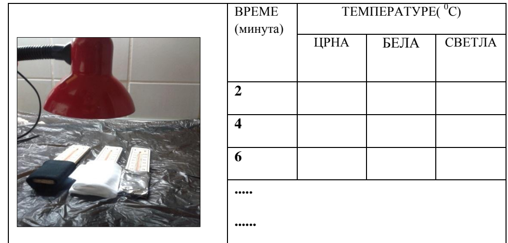
Сл.2а.) Три термометра обавијена црном и белом тканином и алуминијумском фолијом; б) Табела за приказ температура на термометрима мерених сваких 2 минута (током 20-ак минута).
